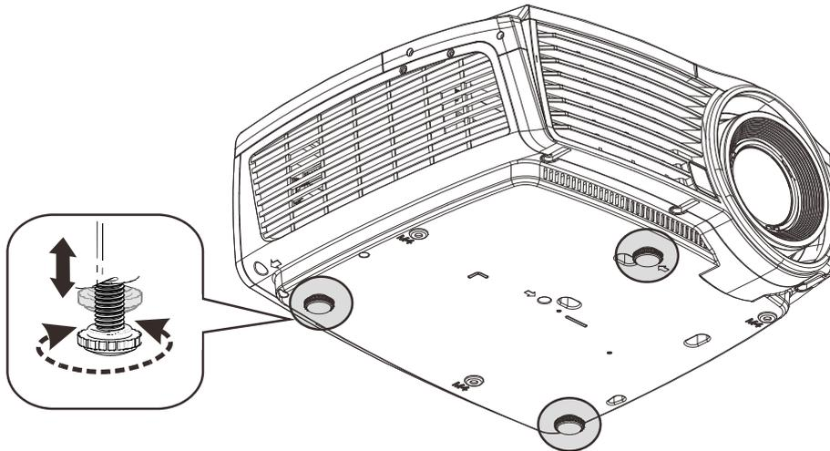
Zur Anpassung des Projektionswinkels drehen Sie den Neigungsregler im oder gegen den Uhrzeigersinn, bis der gewünschte Winkel erreicht ist.
