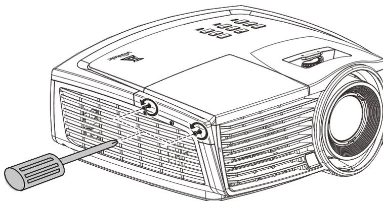
2. Entfernen Sie die Abdeckung des Lampenfachs.
