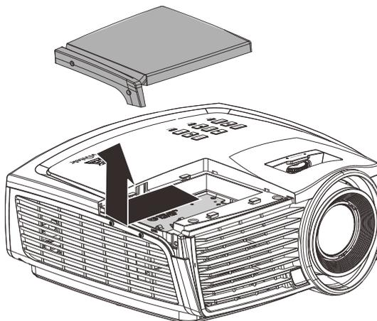
3. Lösen Sie die drei Schrauben am Lampenmodul.
